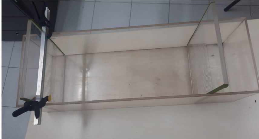
Figura 1: scatola trasparente e piani verticali per livellare la sabbia
