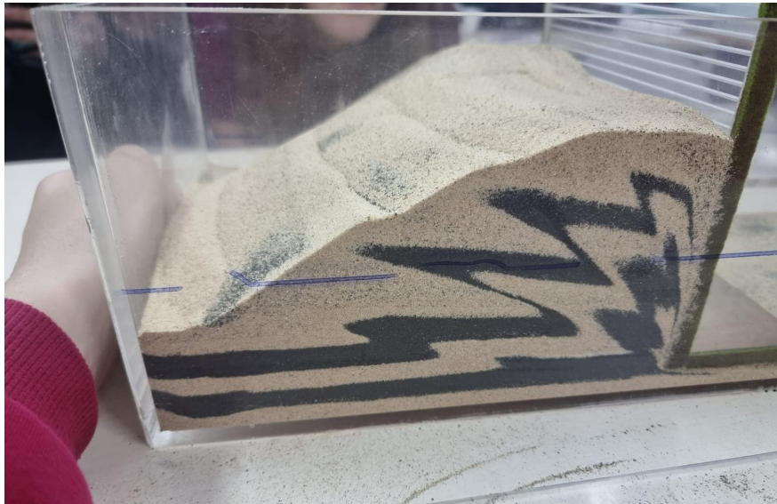
Figura 7: Modello finale con deformazioni superficiali e strutture a pieghe
