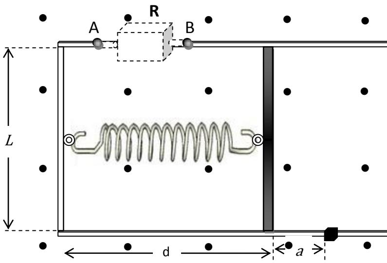
Una barretta metallica, di massa  $m$ , può scorrere lungo i due binari paralleli di una guida ad U anch’essa metallica. La barretta, di lunghezza  $L$ , è collegata al lato della guida parallelo ad essa mediante una molla fissata con materiale isolante. Il tutto è immerso in un campo magnetico uniforme e costante  $\vec{B}$ , ortogonale al piano della guida.
