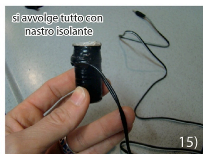
Figura A1.2_1 - Come si costruisce la bobina del sismometro. Clicca qui per vedere il video di come arrotolare il filo di rame.
