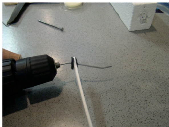
Figura A1.2_16. Come realizzare gli accessori per il funzionamento della tavola vibrante.
