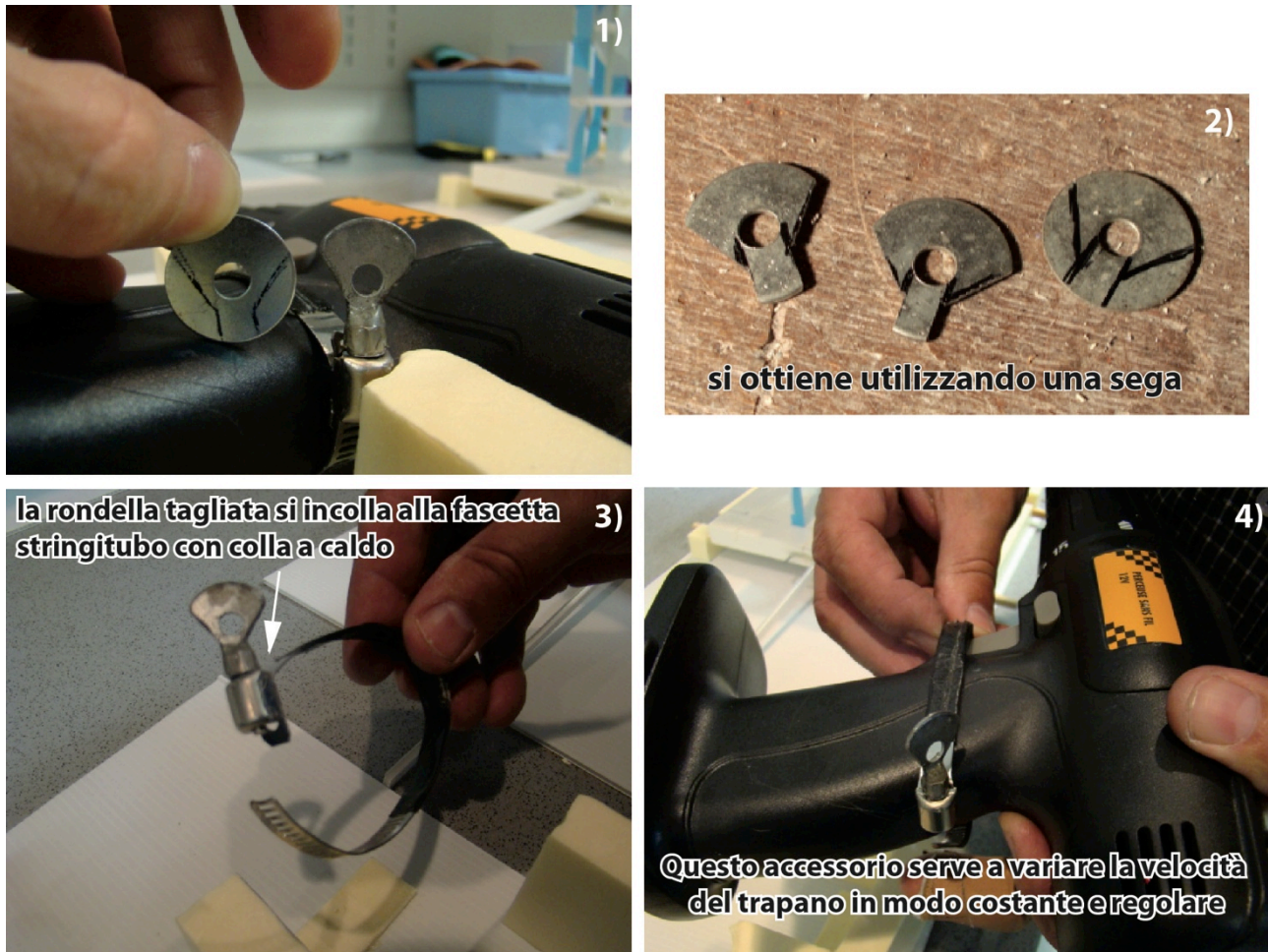
Figura A1.2_13. Come realizzare il collare per il trapano avvitatore.
