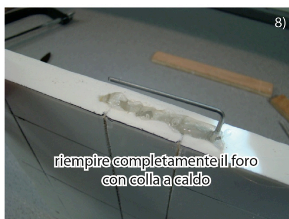
Figura A1.2_9. Come realizzare ganci e inserirli nelle basi di polistirene estruso.
