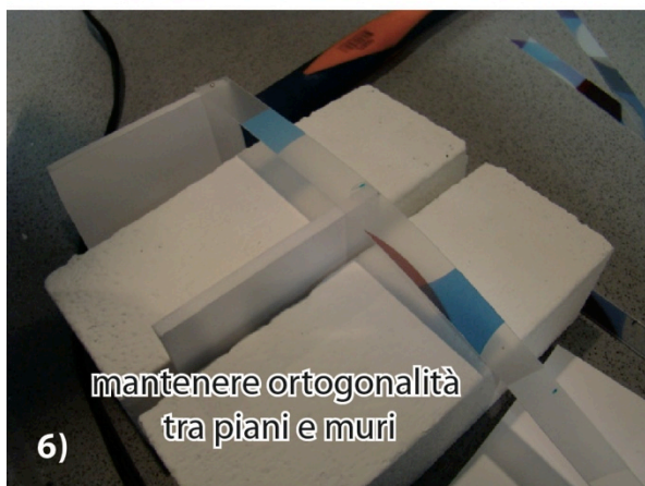
Figura A1.2_6. Come montare gli edifici 'stabili'.
