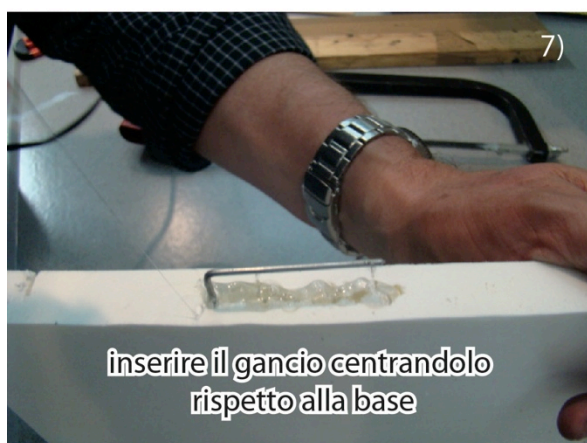
Figura A1.2_9. Come realizzare ganci e inserirli nelle basi di polistirene estruso.
