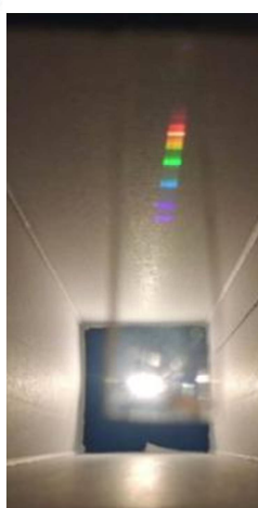
Figura 4: realizzazione dello spettroscopio
