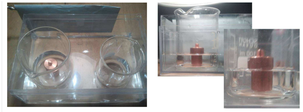
Figura 4: un bicchiere di plastica trasparente immerso in una vaschetta di acqua permette di realizzare la situazione opposta in cui gli indici di rifrazione del diottro e del mezzo esterno si invertono. La faccia della vaschetta da cui si osserva deve essere piana.
