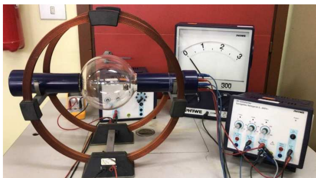
Esempio di apparato sperimentale utilizzato per studiare il moto di un elettrone in un campo magnetico
